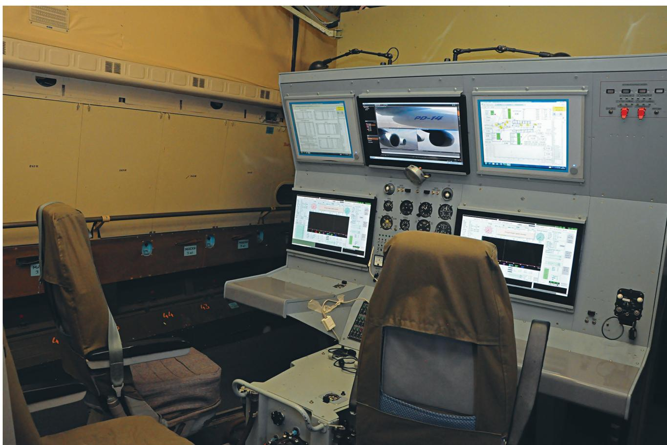
Рабочее место испытателей в обитаемом отсеке летающей лаборатории Ил-76ЛЛ
