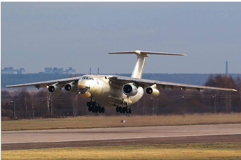
**Посредством СБИ ГК «МЕРА» проведены лётные испытания двигателя ПД-14 в составе летающей лаборатории ОАО «ЛИИ им. М. М. Громова»**
