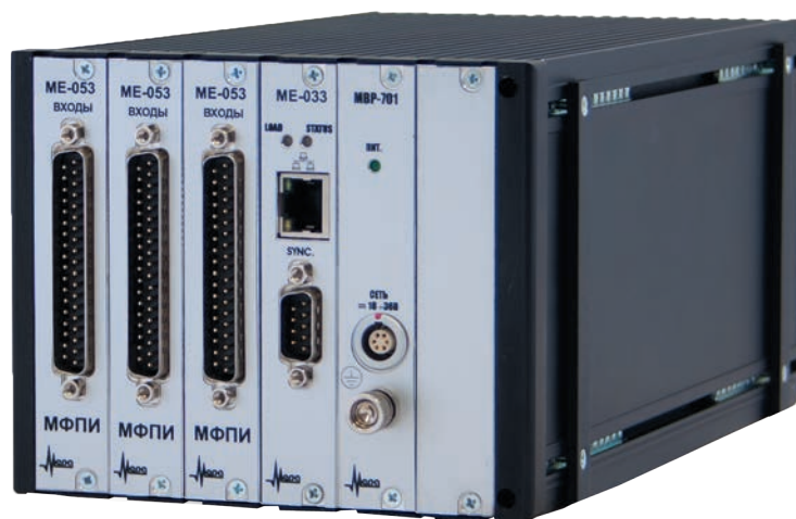
Измерительный комплекс для бесконтактного контроля состояния лопаток турбин MIC-1200
