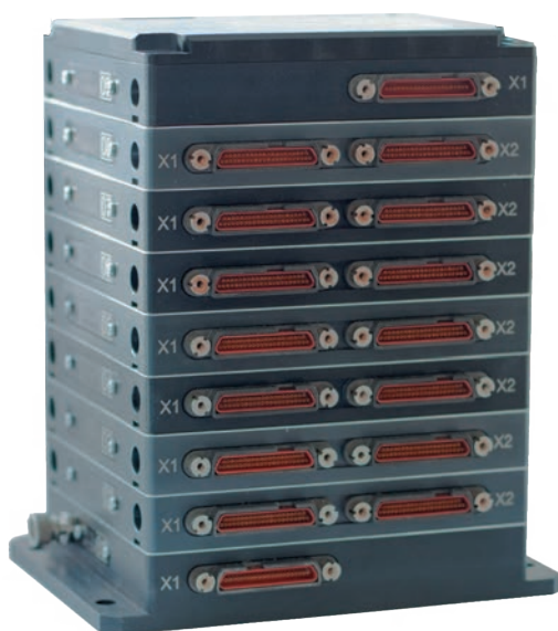
Бортовой измерительный комплекс MIC-710
