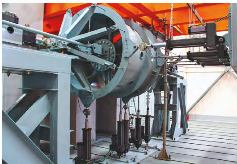
Зал статических испытаний АО «ОДК-Авиадвигатель»
