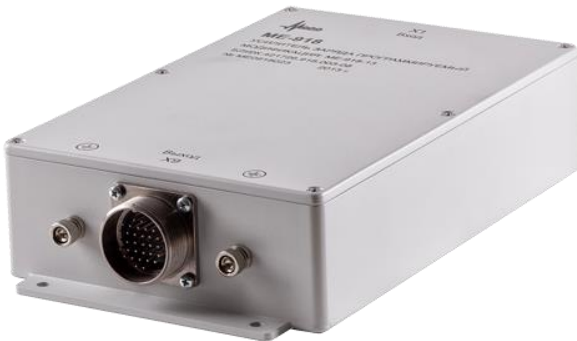
Рис. 5-Модуль ME-918-13 (Групповой входной разъем расположен симметрично выходному. Типы разъемов различные для исключения ошибочного соединения)
