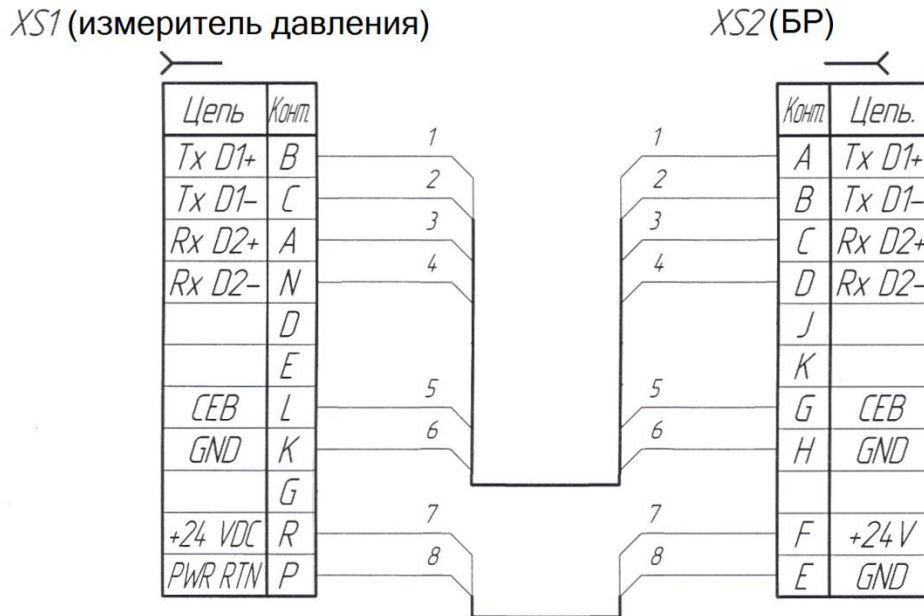
Рисунок В.3 - Схема кабеля БЛИЖ.431583.011.504
