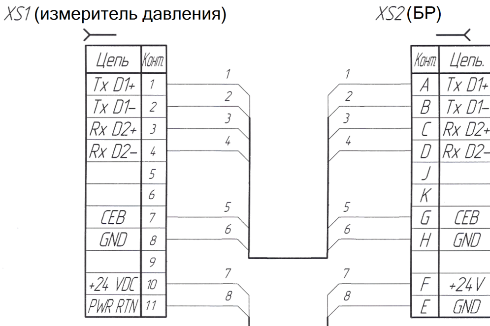
Рисунок В.4 - Схема кабеля БЛИЖ.431583.011.325
