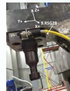
Тензодатчики, расположенные на адаптере
