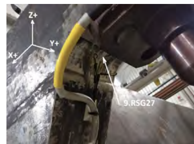
Тензодатчики, расположенные на адаптере
