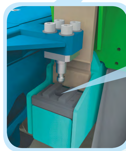
Позиционирование стыковки адаптера ДМП
