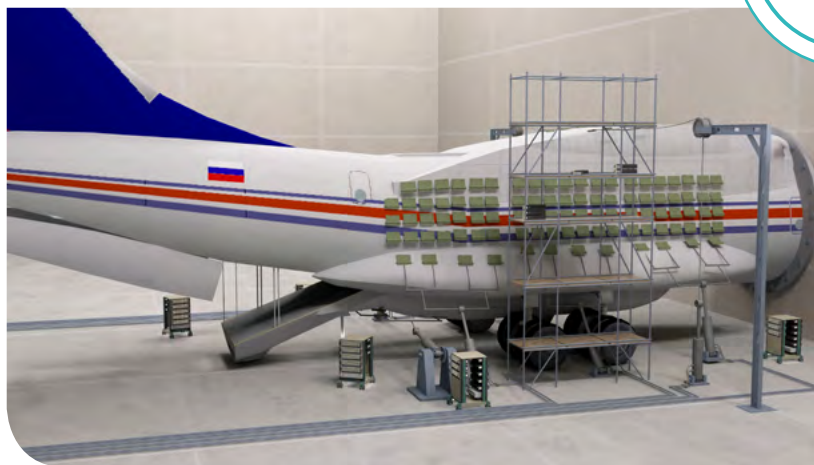
Установки воспроизведения комплексных нагрузок (температура, давление, вибрации, статическое нагружение)
