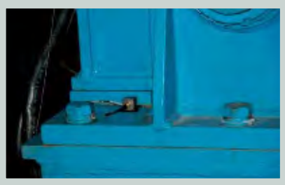
Акселерометр TB1 на задней опоре ТУА
