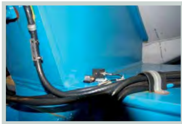
Акселерометры TB2, TB12 на переднем ложементе ТУА
